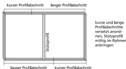
Position der Stützprofile bei Profillängen 4,81 m bis 7,0 m:
