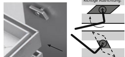
Position der Stützprofile bei Profillängen 2,51 m bis 4,8 m:
